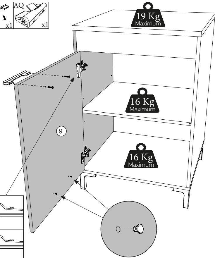
Utiliser une cale pour percer les trous de la poignée
